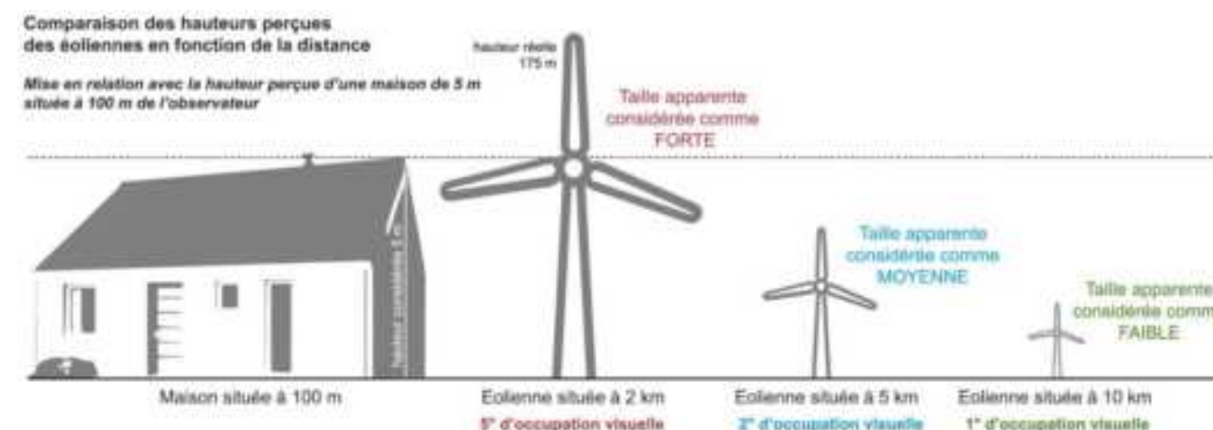
Figure 33 : Comparaison des hauteurs perçues des éoliennes en fonction de la distance (Source : BE JC)
