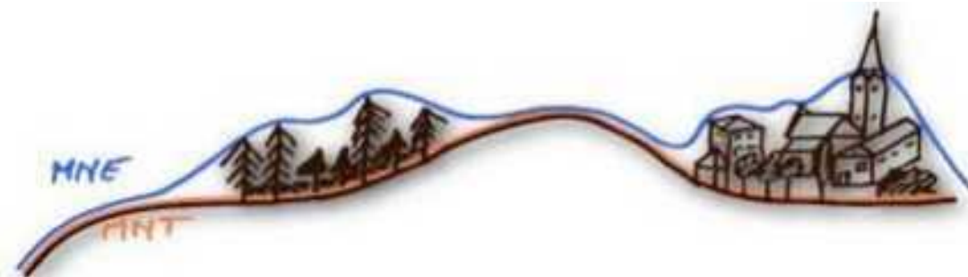
Figure 30 : Modèle Numérique de Terrain et Modèle Numérique d'Élévation (Source : BE JC)
