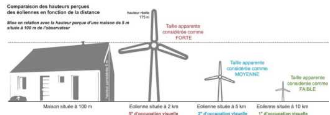
Figure 13 : Comparaison des hauteurs perçues des éoliennes en fonction de la distance (Source : BE JC)
