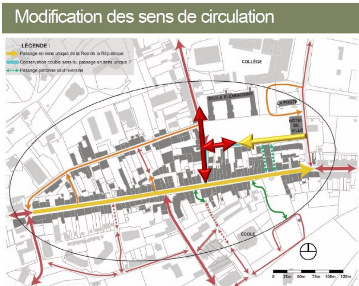
FIGURE 24 - Projet de requalification de la Rue de la République - modification des sens de circulation
