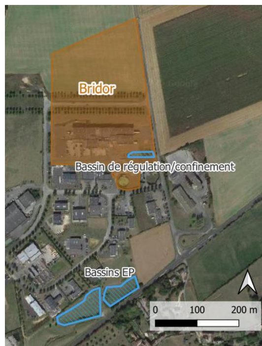
Figure 7-19 : Bassins de la zone Expansia
