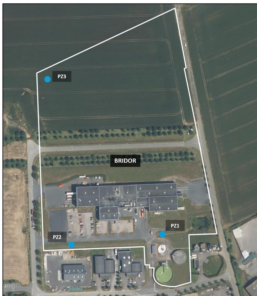
Figure 4-1 : Localisation des forages du site BRIDOR
