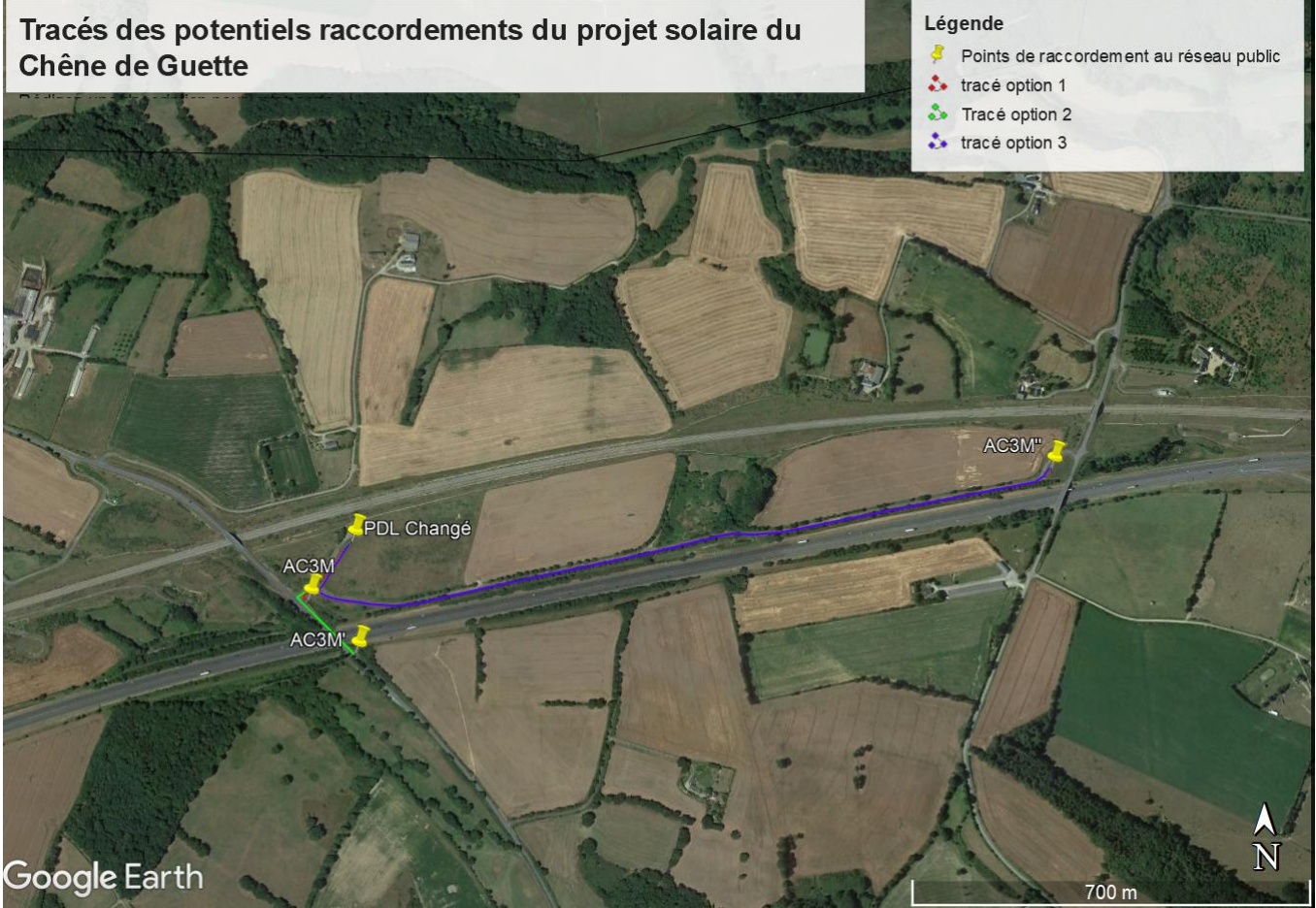
Tracé prévisionnel du raccordement de la centrale
