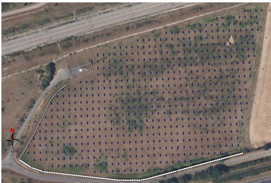
Figure 21 : Tracé de l'écran modélisé – hauteur : 3 m
