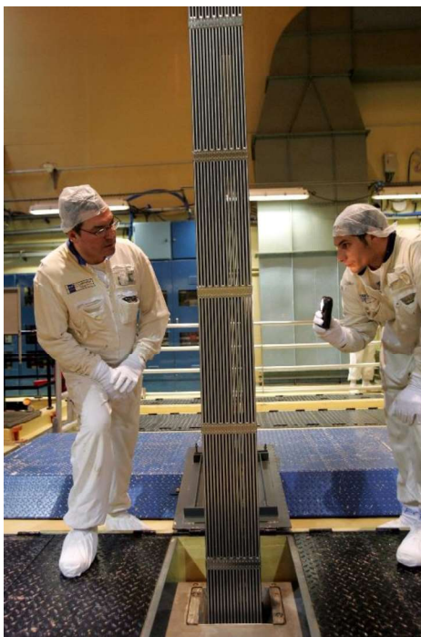
Figure 4. Assemblage de combustible (Copyright EDF / SAUTERAU Frédéric)
