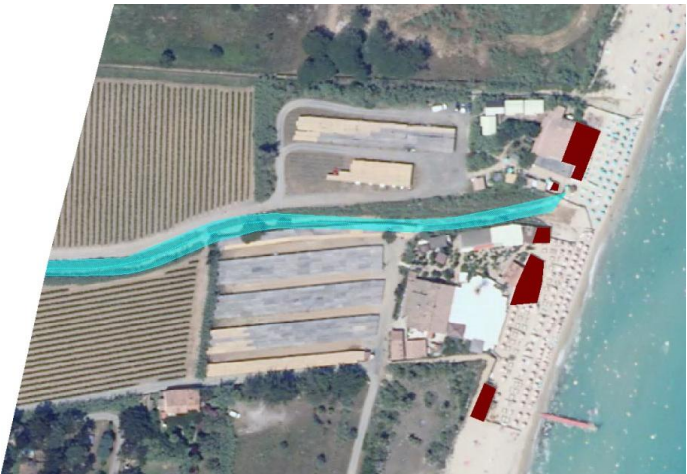
Le débouché du cours d'eau est aujourd'hui encadré par des constructions qui figurent des obstacles en cas de crues.
