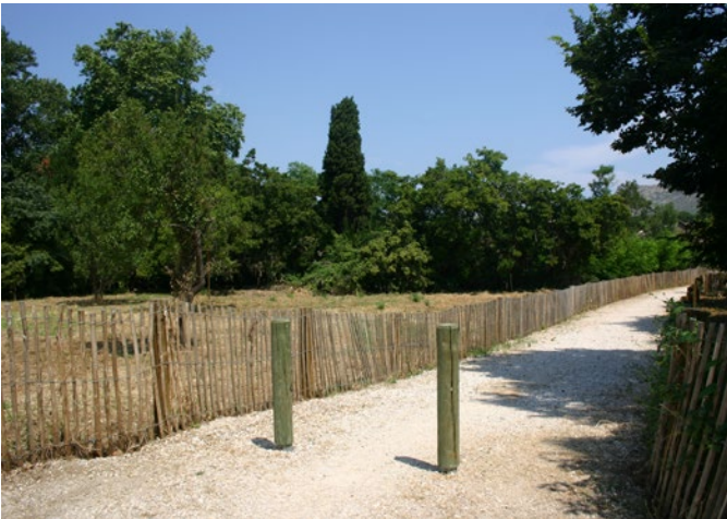
Fig 58 : Les ganivelles : un moyen «local» d’assurer la contention des flux piétons, que ce soit sur la dune ou dans les espaces arrière-littoraux
