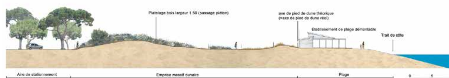
Fig 128 : Coupe de principe sur les établissements de plage démontables
