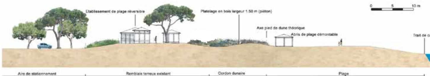
Fig 129 : Coupe de principe sur les établissements de plage réversibles
