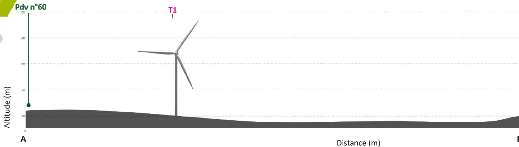
Coupe topographique entre le point de prise de vue et l'éolienne la plus proche (T1), avec une zone de recul de 500 m.
