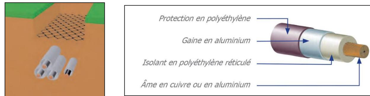
Figure 7 : Principe d'enfouissement et coupe d'un câble de raccordement souterrain (source : RTE)
