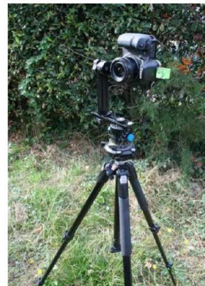
Figure 1 : dispositif d'acquisition d'images en séquence panoramique
