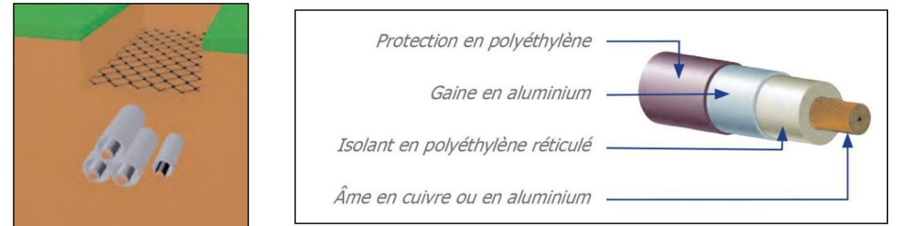
Figure 12 : Principe d'enfouissement et coupe d'un câble de raccordement souterrain (source : RTE)
