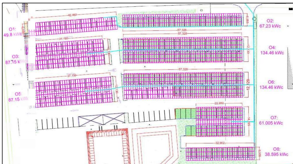
Figure 11: Position des panneaux photovoltaïques au niveau du parking personnel
