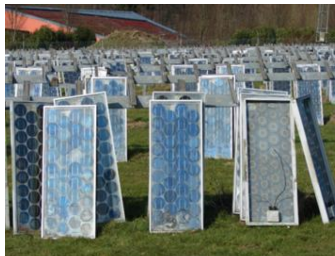
Figure 103 : Panneaux photovoltaïques en fin de vie (source : Soren, 2015)
