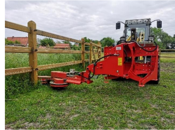
Figure 102 – Exemple d'entretien de clôture à l'aide d'une faucheuse escamotable (Crédit : PM Environnement)
