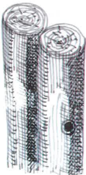
jumelage des poteaux assemblage boulonné
