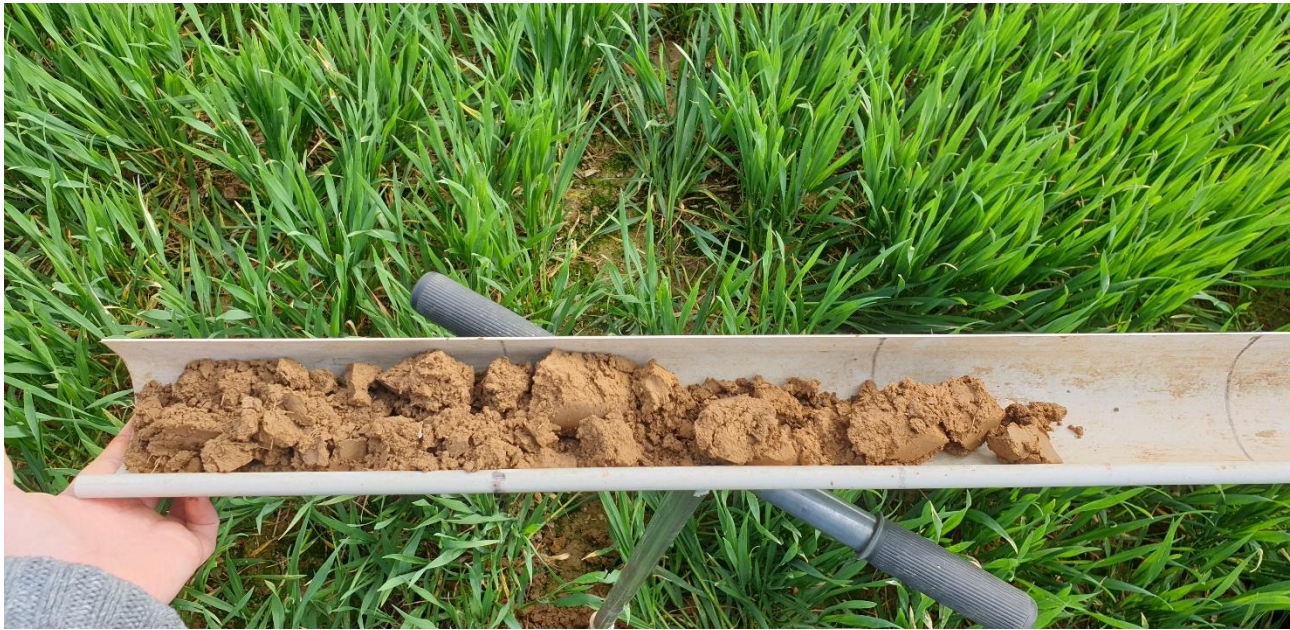
Figure 4 : Illustrations des brunisols avec limons et argiles prélevés lors des sondages pédologiques
