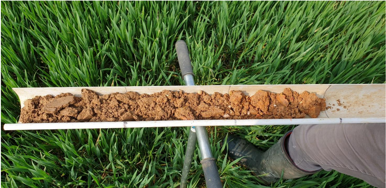
Figure 5 : Illustrations des brunisols avec limons, argiles et éléments grossiers prélevés lors des sondages pédologiques
