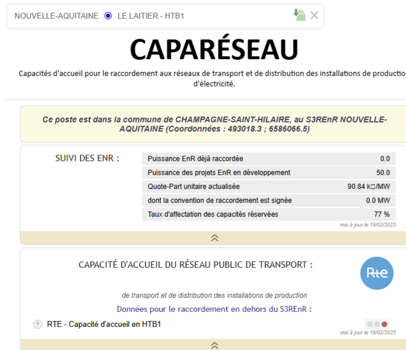
Figure 44 : Caractéristiques du poste source « LE LAITIER » en février 2025
