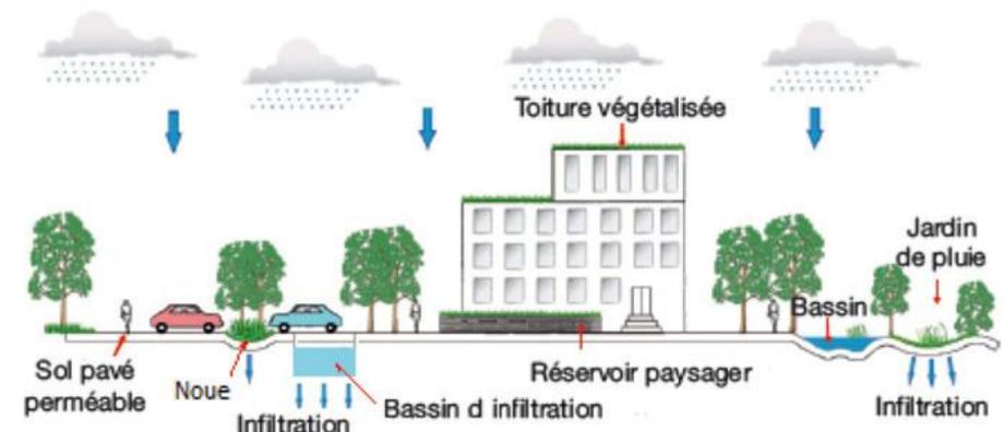
Figure 3 : Exemple de gestion des eaux pluviales d'un immeuble © DR@
