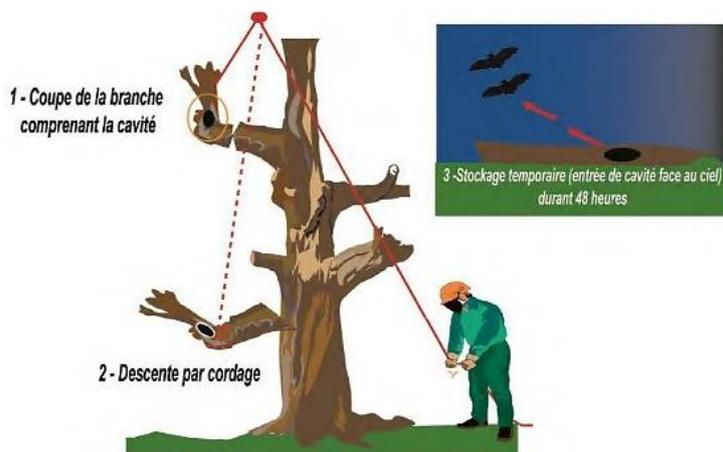
Schéma de principe d'un abattage doux
