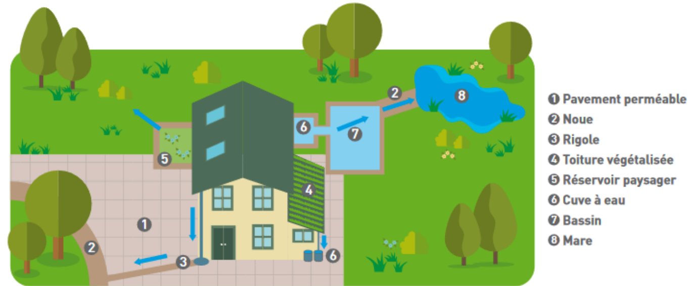
Exemple de différentes techniques alternatives possibles pour gérer les eaux pluviales d’une maison Source : SYMASOL
