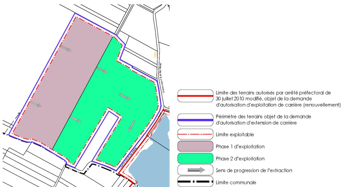
▼ **Illustration : Plan de remblayage de l'exploitation**
