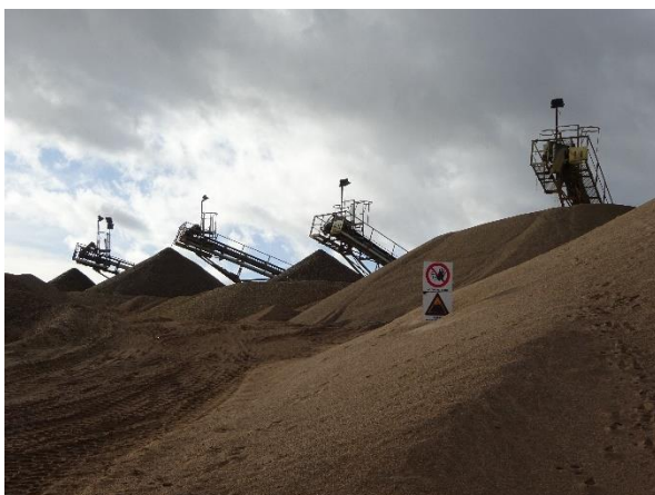
Figure 15 : Stockage de produits finis à l'aplomb des sauterelles [à gauche] et tunnel de reprise [à droite] (ENCEM)
