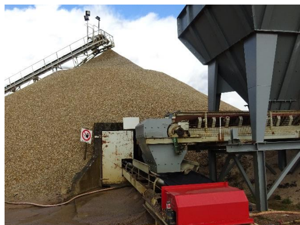
Figure 15 : Stockage de produits finis à l'aplomb des sauterelles [à gauche] et tunnel de reprise [à droite] (ENCEM)
