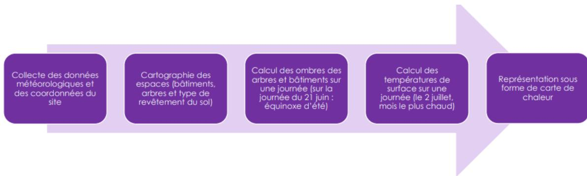
**Figure 1** : Exemple de la méthode utilisée dans le logiciel ICE TOOL pour un projet similaire.
