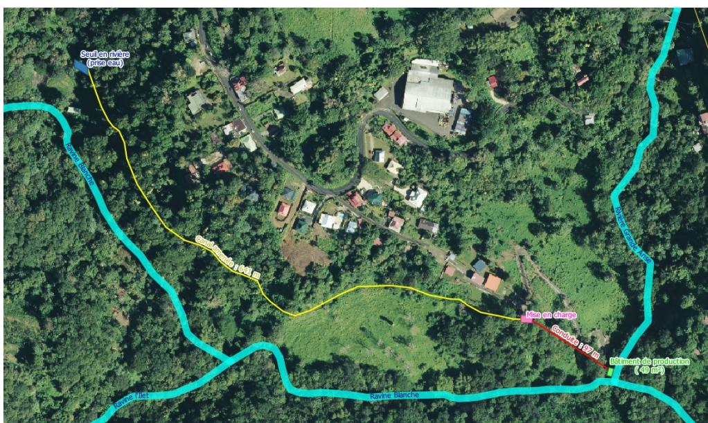
Figure 8 : Tracé des ouvrages et équipements de la microcentrale de Dolé
