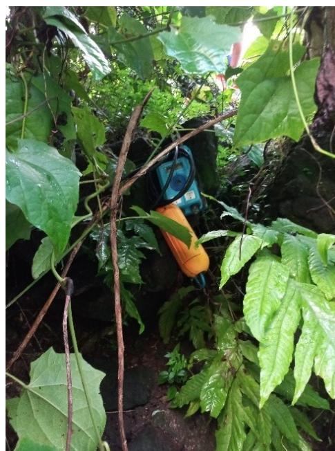
*Figure 10 : Enregistreur de données de la sonde piézométrique installée*
