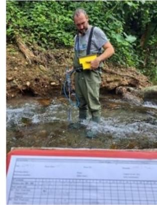
*Figure 3 :Principe de répartition des points de mesure des vitesses en fonction de la hauteur d'eau et mesure sur le terrain*
