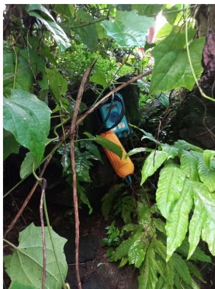
Figure 4 : Enregistreur de données de la sonde piézométrique installée
