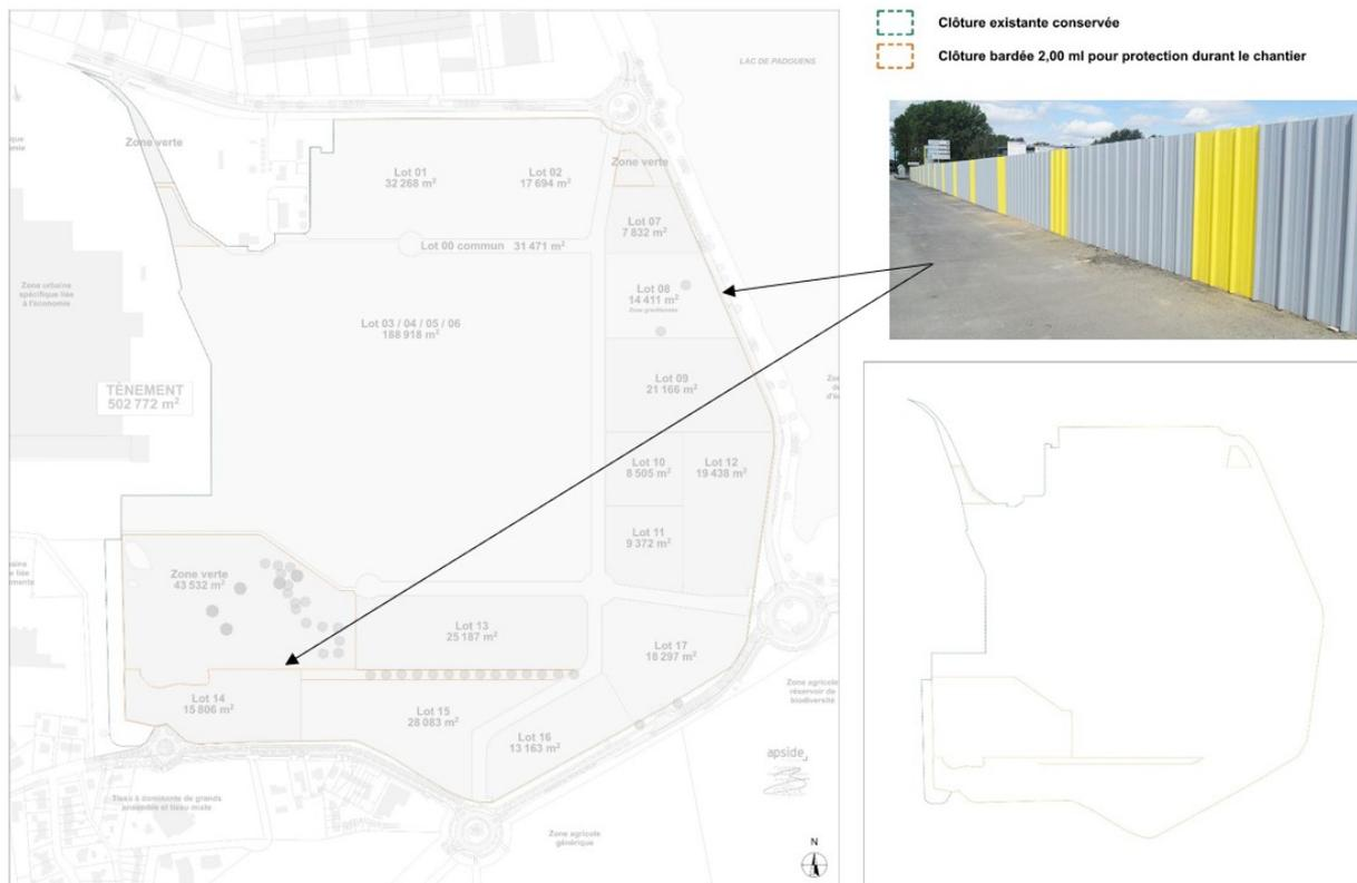
**Figure 76 : Plan de répartition des clôtures en phase chantier**
