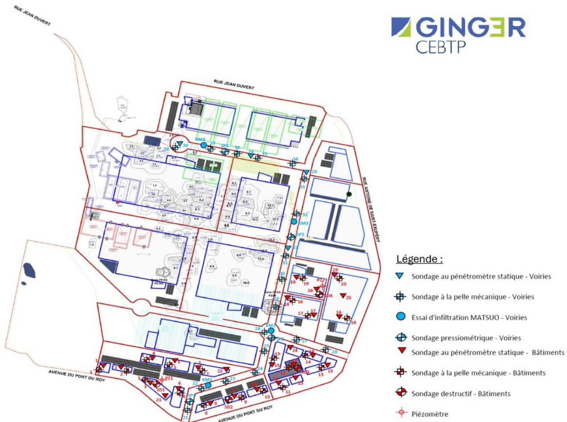
**Figure 24 : Plan de localisation des sondages et piézomètres**
