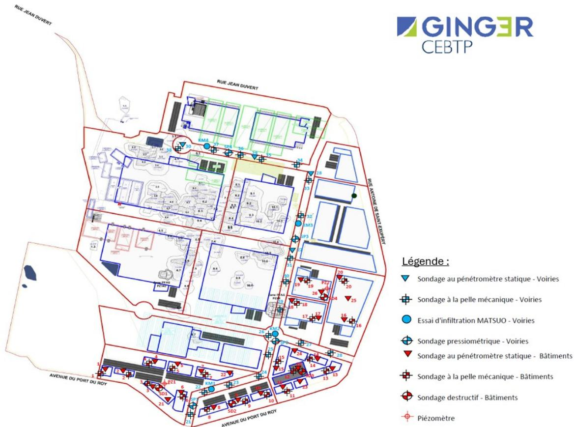
**Figure 22 : Plan de localisation des sondages géotechniques**
