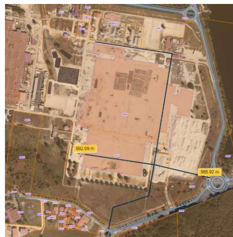
10. Mesure des linéaires de réseaux de chaleur nécessaires (sources : géoportail.fr)
