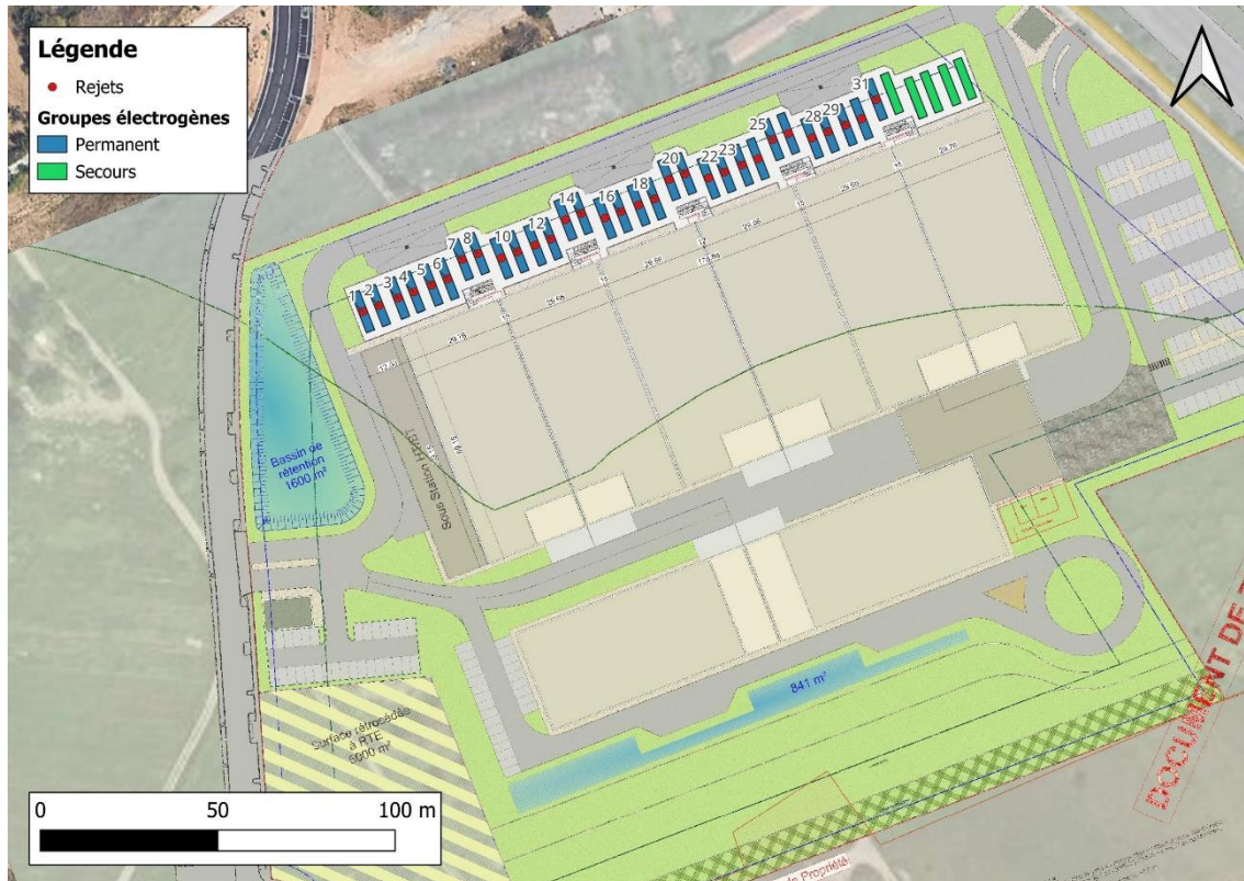
Figure 3 : Localisation des rejets canalisés
