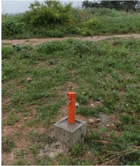
Figure 1 : Photographie du piézomètre SC1+PZ
