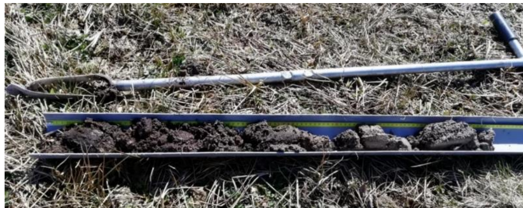
Figure 20 : Exemple de carottage réalisé à la tarière manuelle Edelman (source : EODD, 2022)
