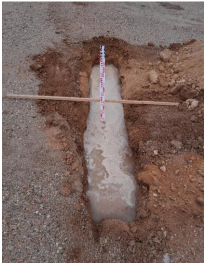
Essai MATSUO en cours
