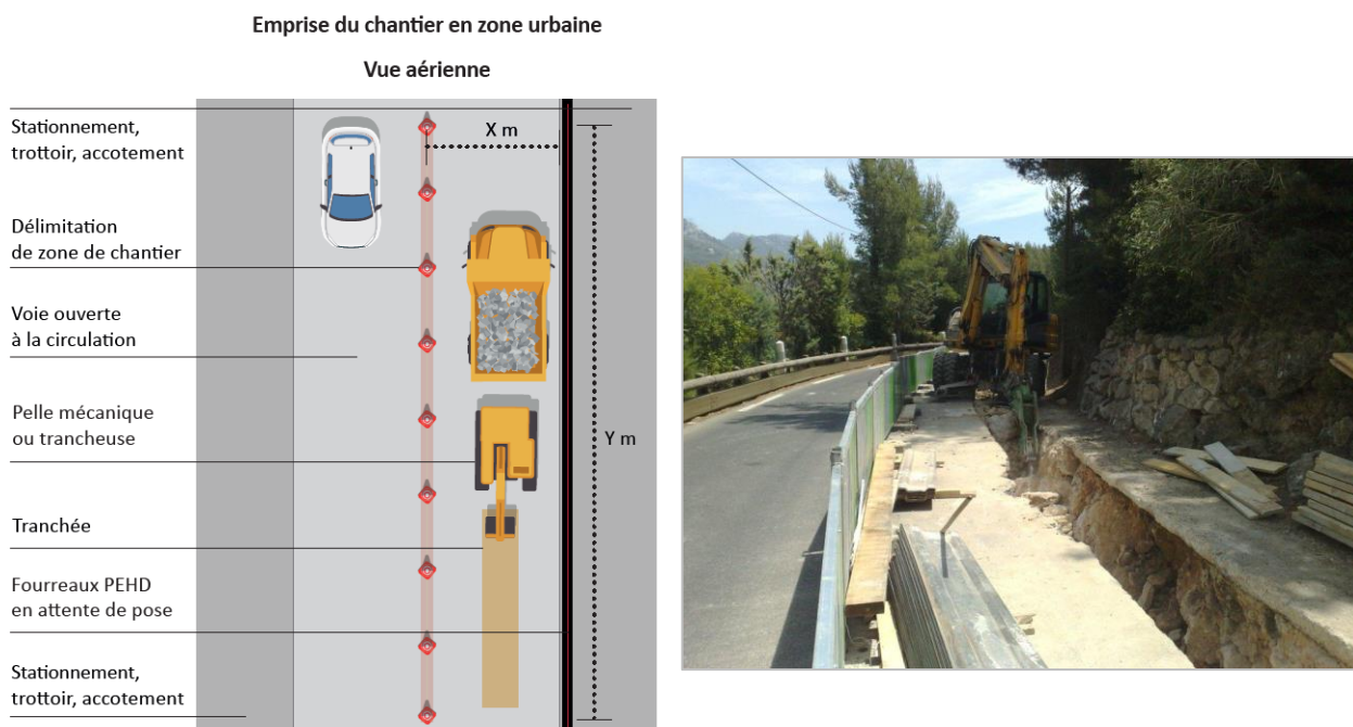
Illustration d'un chantier à l'emprise réduite
