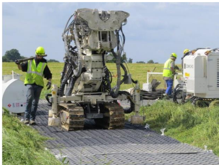
Exemple d'accès provisoire sur plaques en métal
