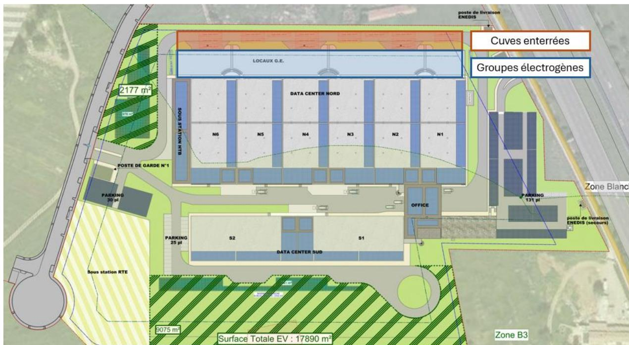
Figure 85 : Localisation des groupes électrogènes et des cuves de HVO enterrées
