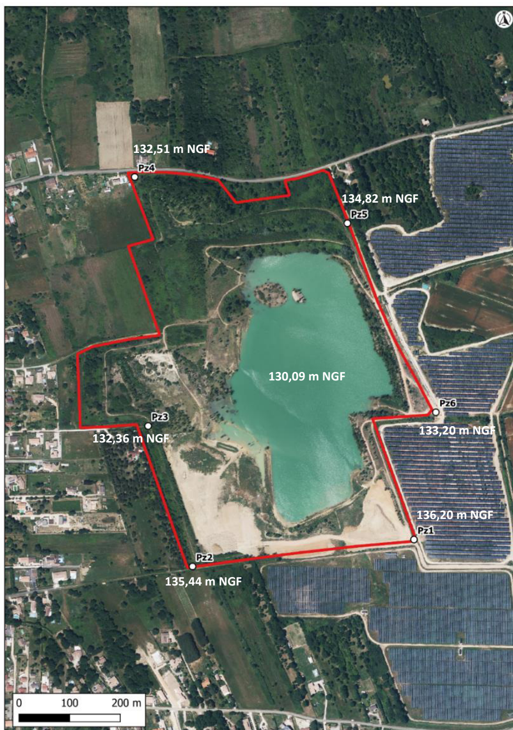
Figure 4 : Résultats des mesures piézométriques du 15/10/2024
