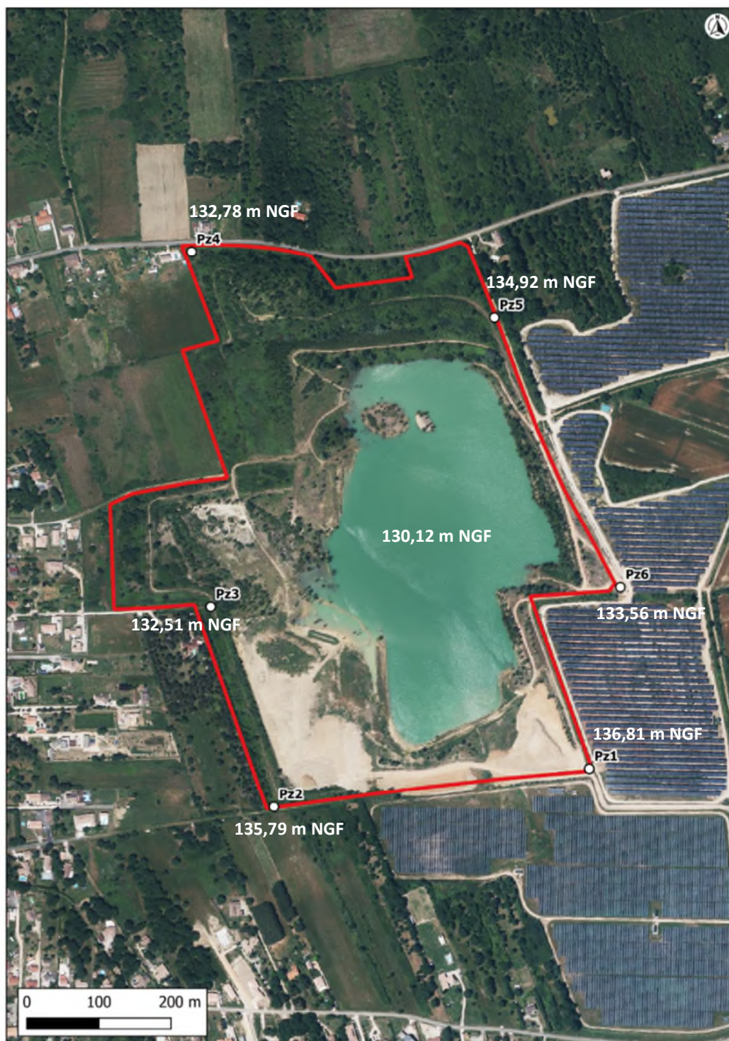
Figure 3 : Résultats des mesures piézométriques du 24/04/2024
