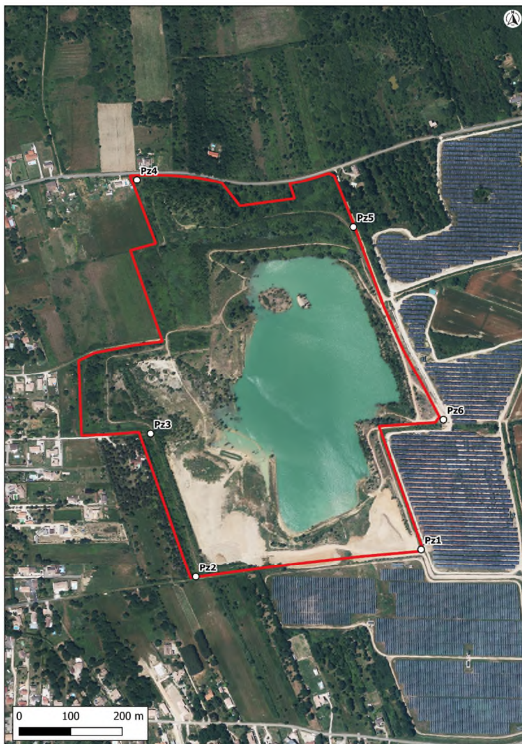
Figure 2 : Localisation des six piézomètres implantés sur le site de Lapeyrière
