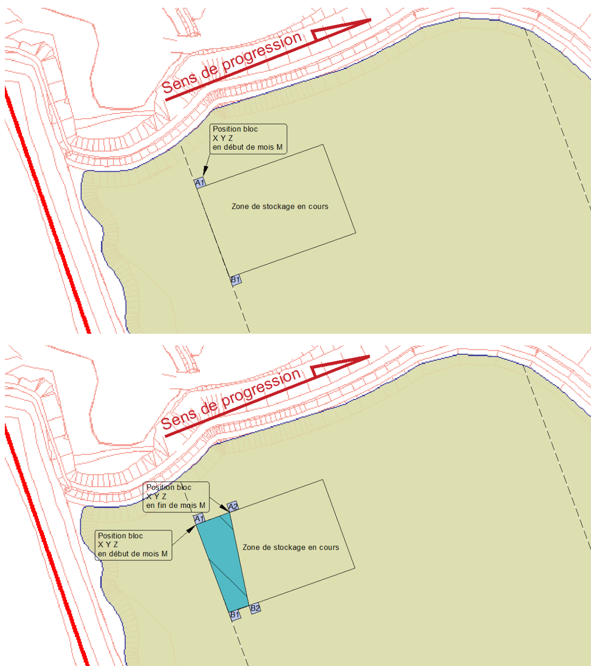
Schéma 10 : Modalités de relevés des dépôts en zone ICPE (ISDI) au cours d'un mois M
