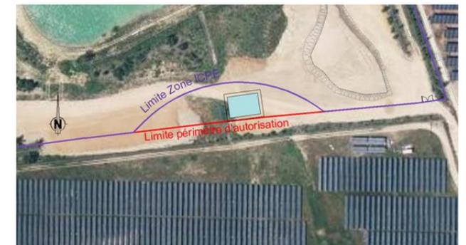
Les ruissellements intérieurs au site projet convergeront vers le plan d'eau. Les ruissellements au droit des emprises aménagées rejoindront gravitairement les zones humides et le plan d'eau.
