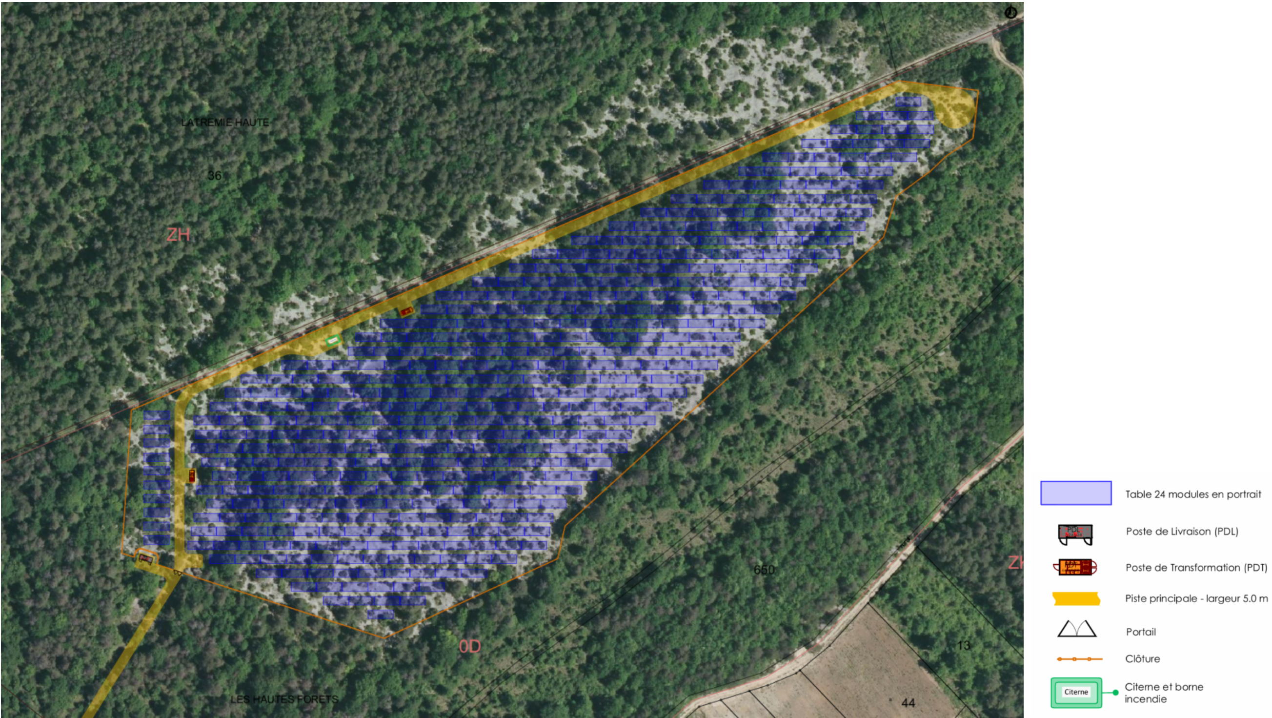
Figure 4-6 : Plan d'implantation final – site des Hautes-Forêts (source : ENERTRAG)
