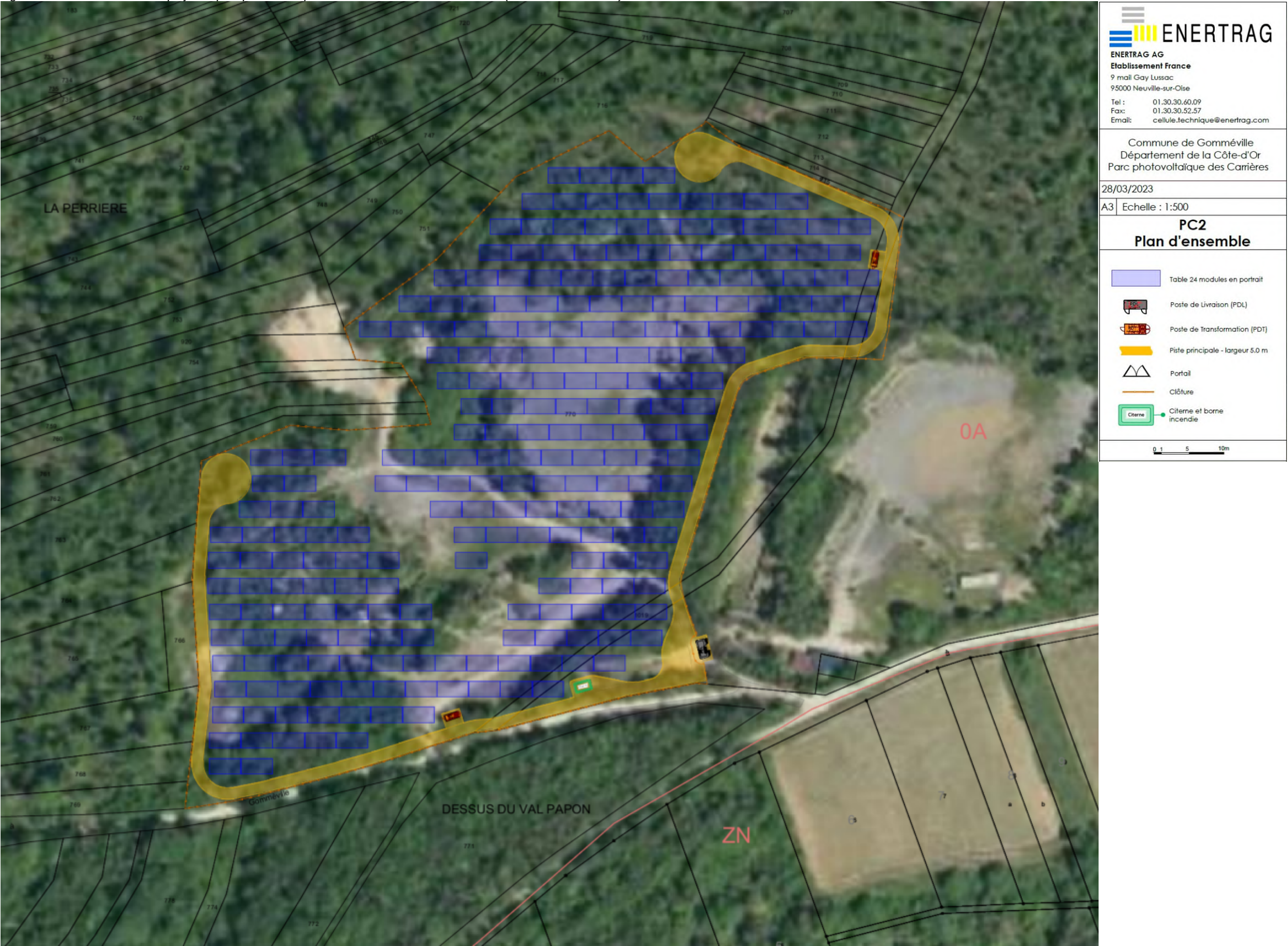
Référence R001-1620405EFO-V01 Figure 2-26 : Plan du masse du projet de parc photovoltaïque au sol sur le site ouest – Carrières (source : ENERTRAG)
