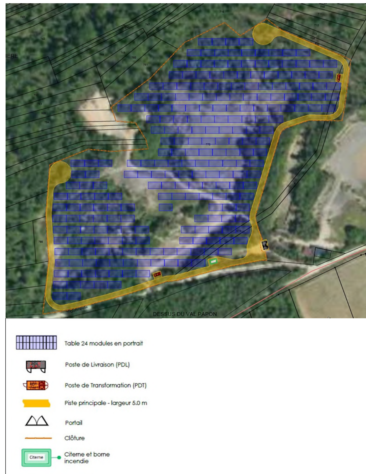
Figure 4-5 : Plan d'implantation final – site des Carrières (source : ENERTRAG)
