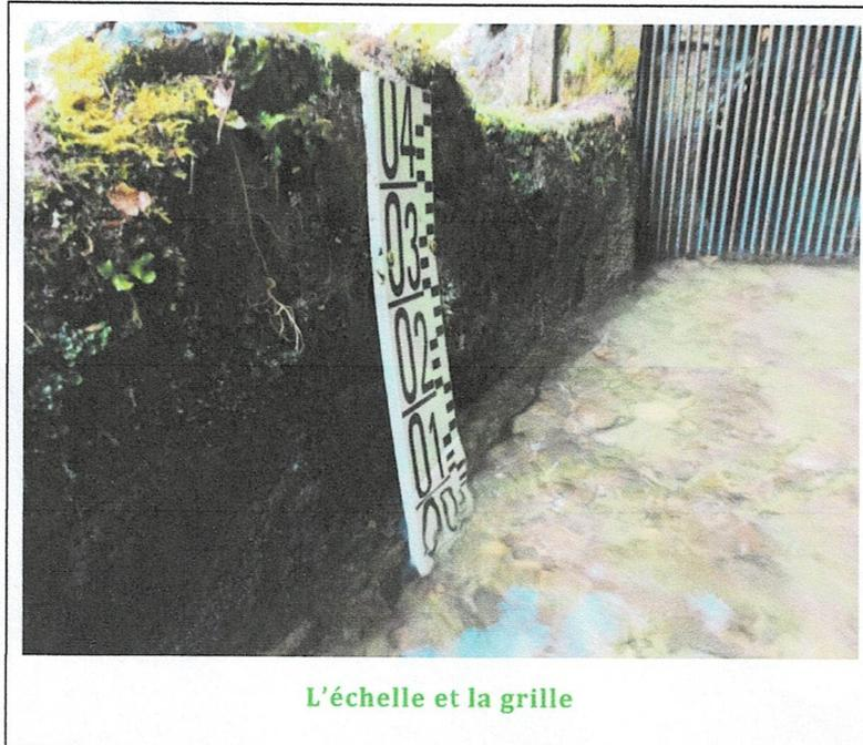
L'échelle est posée au fond du bief. Là où elle a été posée, sa graduation 0 se trouve 5.2 cm sous la cote de fond de conduite amont. Ce qui signifie que le débit est nul en-dessous de 5.2 cm lus sur l'échelle.
