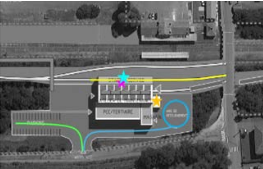
Figure 76 : Disposition des sources de bruit dans la modélisation du SMR
