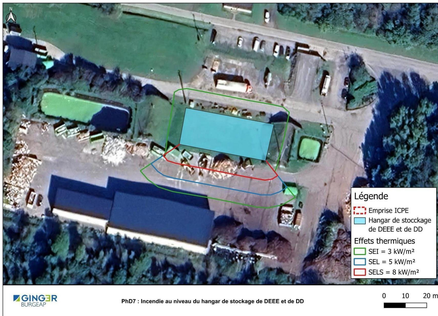
Figure 36 : Effets thermiques de l'incendie généralisé du hangar de stockage de DDEE et de DD – PhD7
