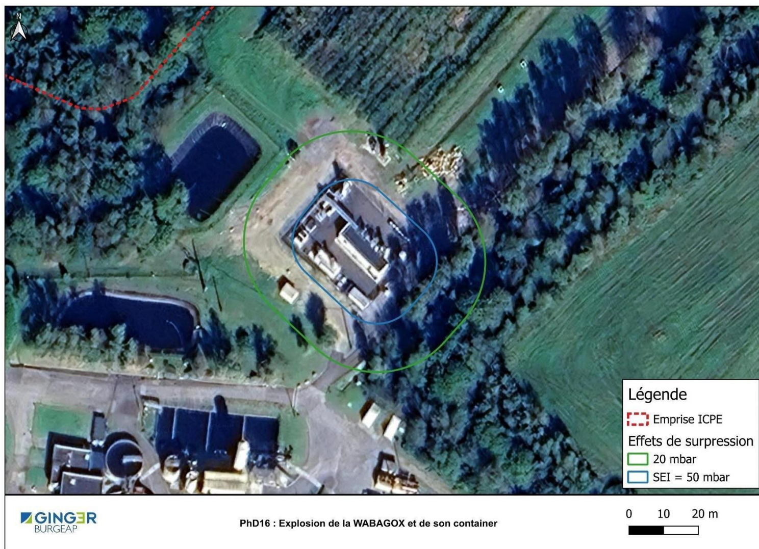
Figure 39 : Effets de surpression à hauteur d'homme suite à l'explosion du container WAGABOX® - PhD16
