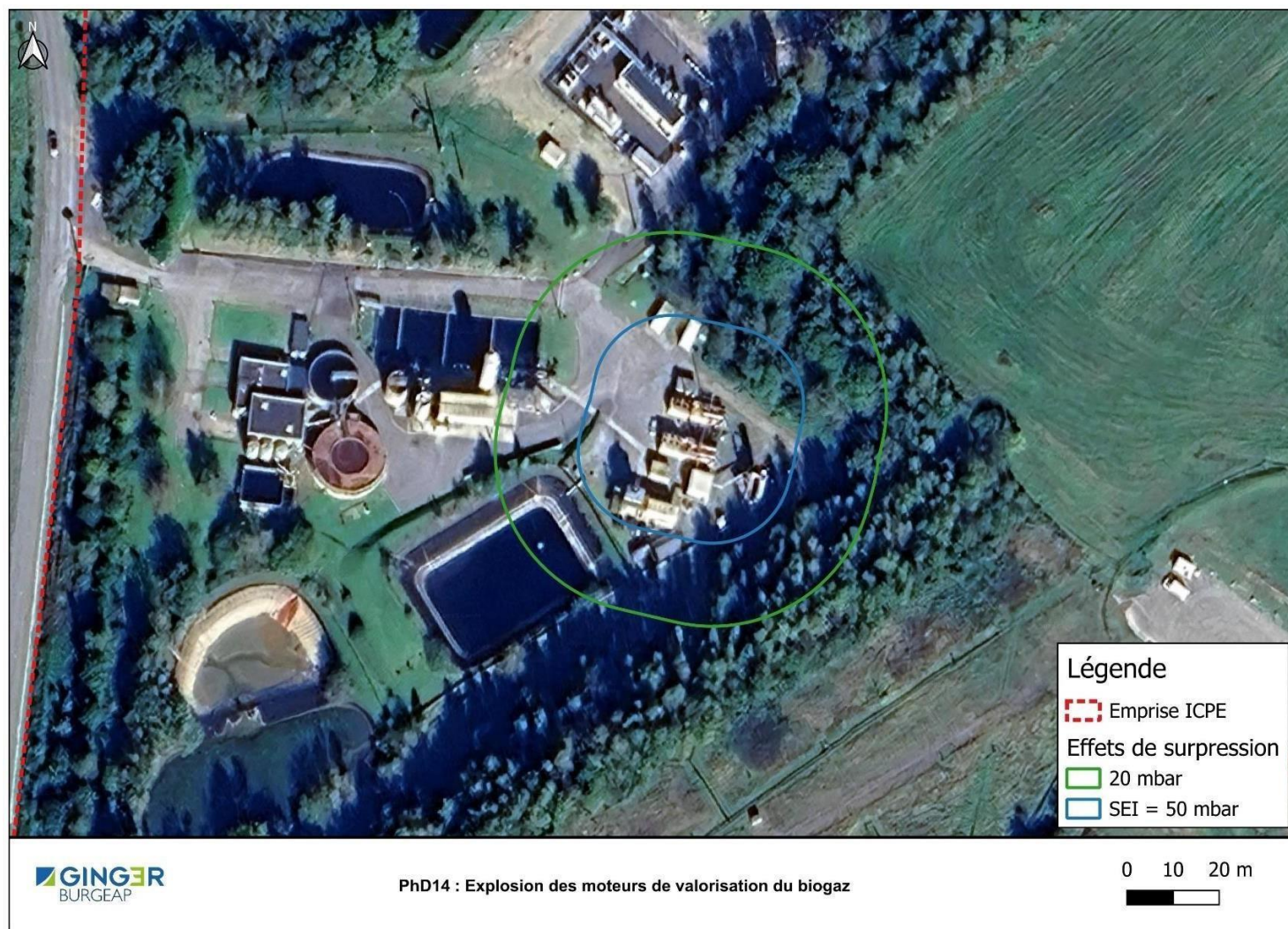
Figure 38 : Effets de surpression à hauteur d'homme suite à l'explosion des moteurs - PhD14
