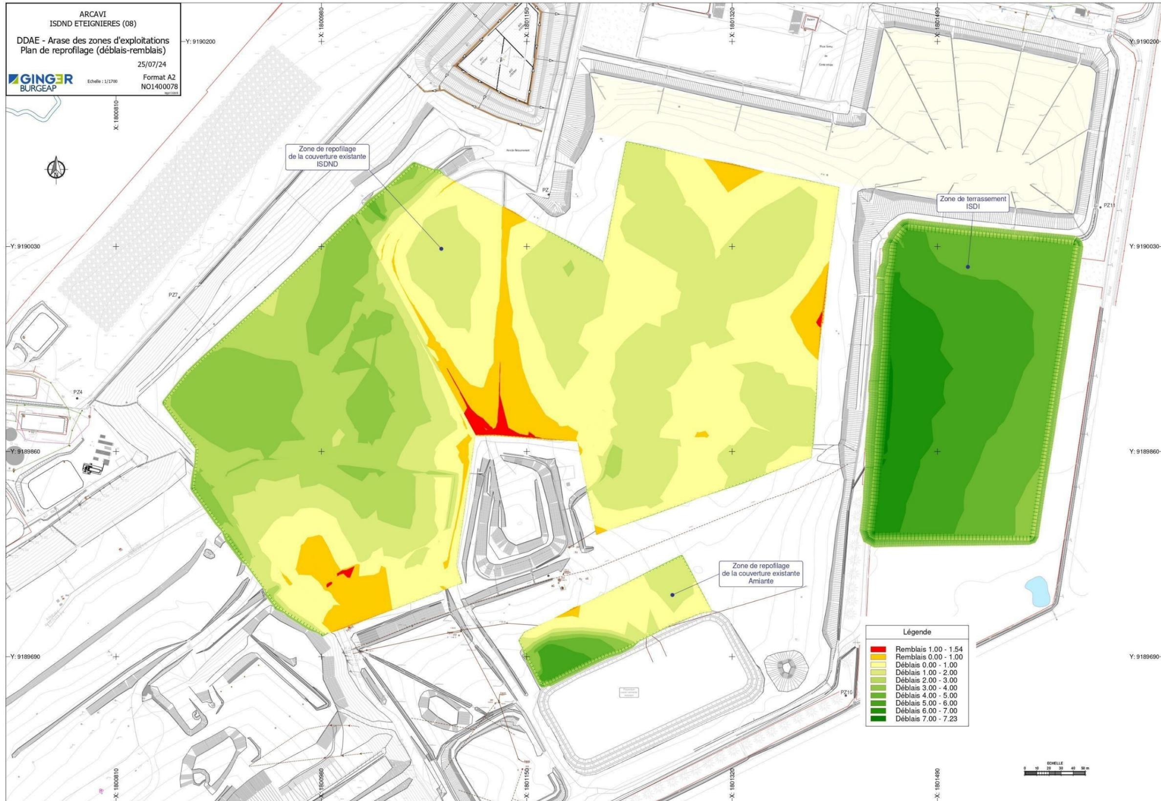
Figure 38 : Plan des déblais / remblais sur le site (source : GINGER BURGEAP)
