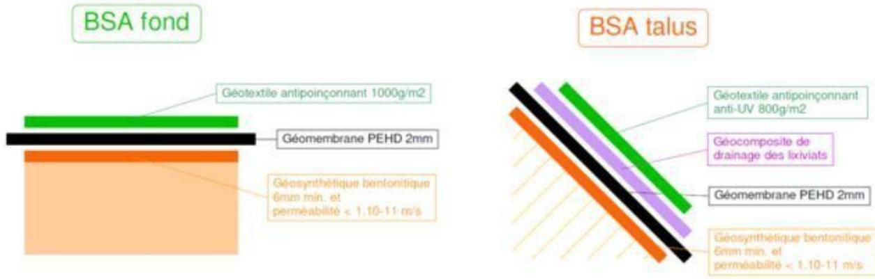
**Figure 42 : Coupe de principe de la BSA au droit de la zone ISDND**
