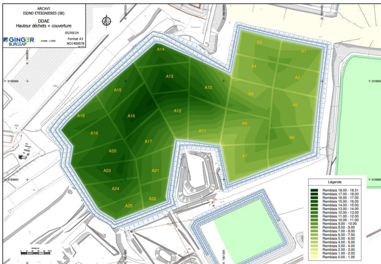
Figure 5 : Hauteurs de déchets + couverture sur l'emprise de la rehausse
