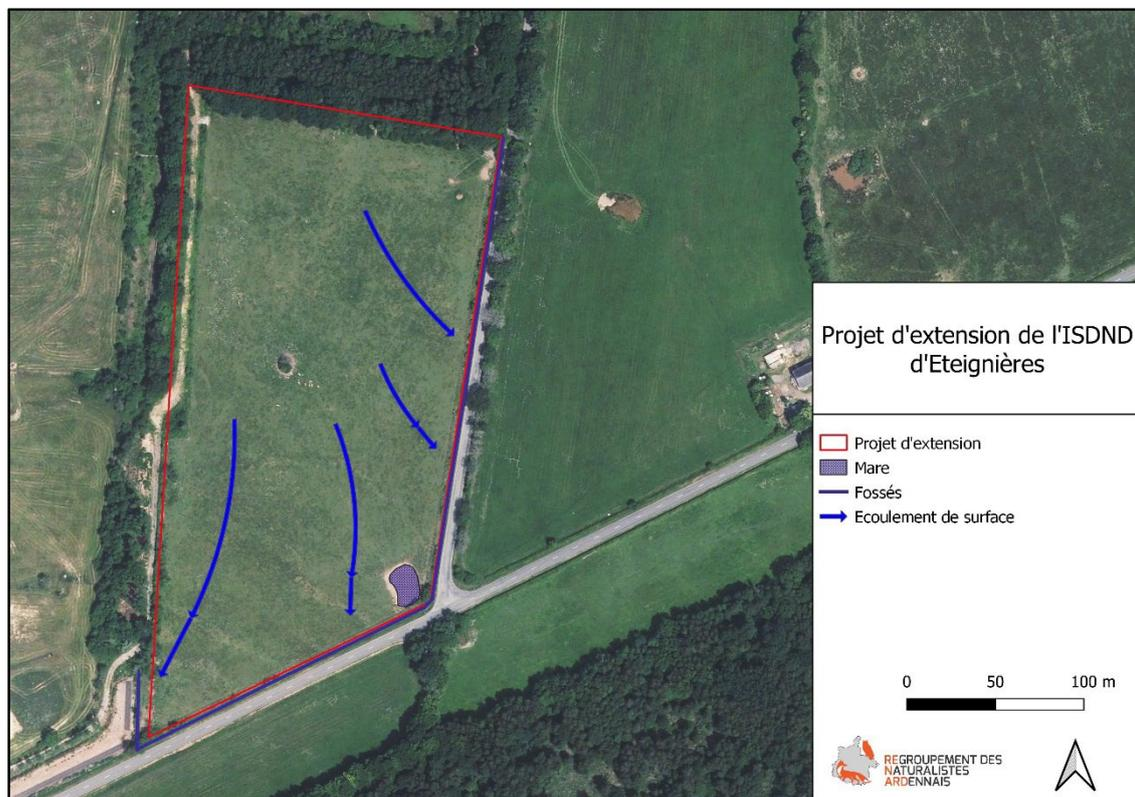
**Figure 7. Hydrologie de surface à l'échelle de la parcelle**
