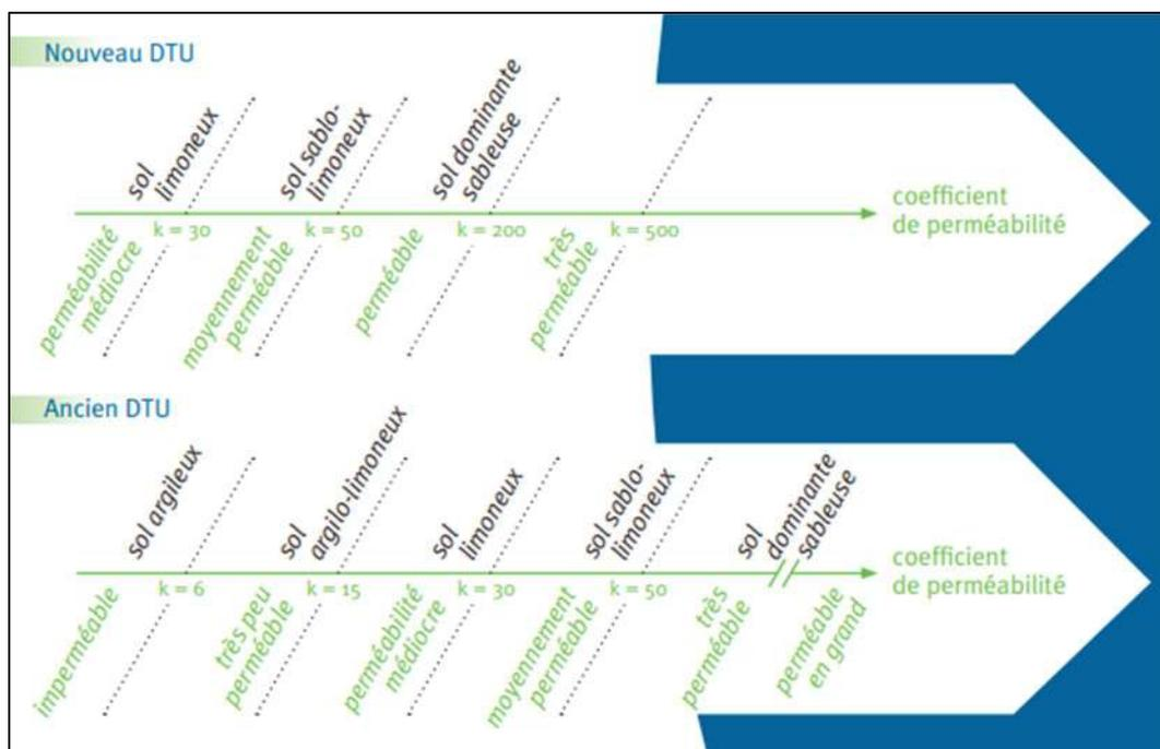
Figure 11 : Classes de perméabilité d'après DTU 64.1 de 2013
