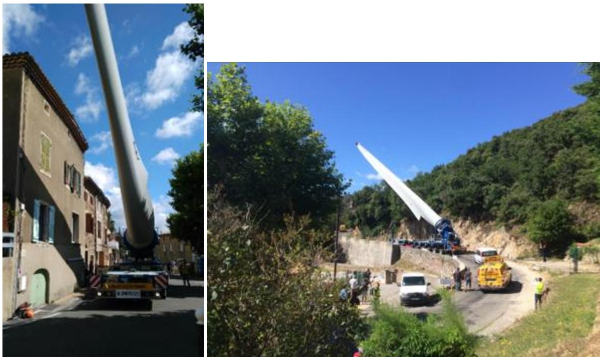
*Figure 4-10: Exemple de transport de pale d'éolienne avec la technologie « Blade lifter » (source : CNR)*
