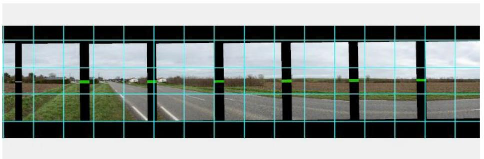
Du fait de l'angle de champ horizontal étendu la projection de sortie nécessaire est cylindrique pour une bonne visualisation de ce type de panorama - comme indiqué, une projection «droite» rectilinéaire induirait d'importantes déformations de perspectives. La définition finale du panorama est calculée de manière à obtenir la meilleure résolution possible pour les mises en pages en 300 points par pouce minimum.
