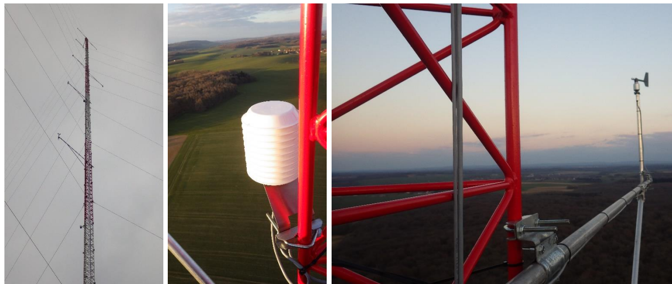
Photographie 2 – Mât de mesure, anémomètres et girouettes (Source : ABO Energy, mars 2016)
