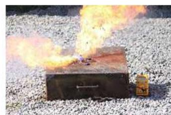
Figure 9 : Détermination du débit calorifique émis lors de l'emballage thermique du pack batterie
