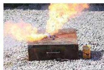
Figure 27 : Détermination du débit calorifique émis lors de l'emballage thermique du pack batterie
